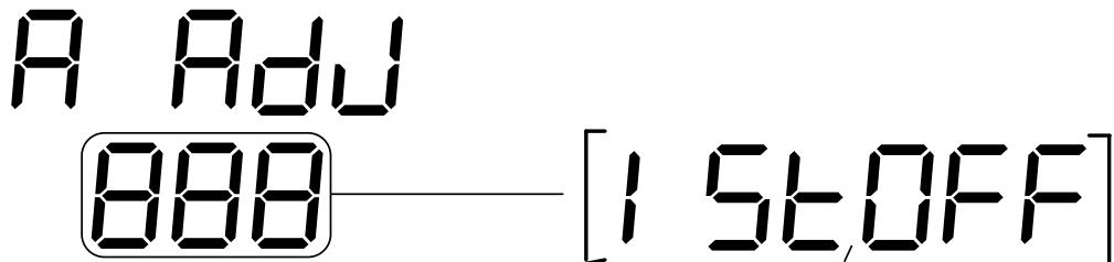
Нажатием кнопки і выполняется переход к режиму ИЗМЕНЕНИЕ ЗНАЧЕНИЯ ПАРАМЕТРА, при котором значение отображаемого параметра мигает.
